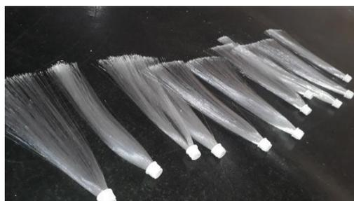
**Figura 3** – Fibra óptica polimérica transparente
