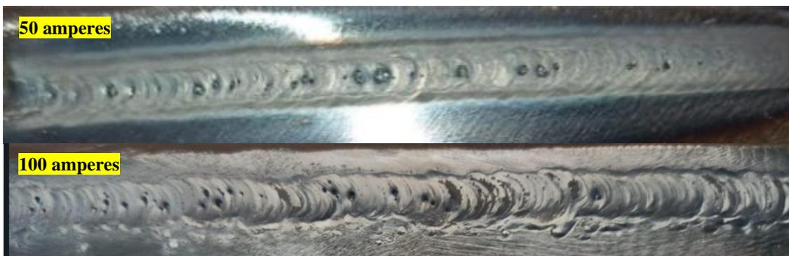
**Figura 4** – Cordões com velocidade de 2,5 e amperagens de 50 e 100
